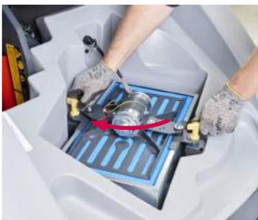
16. Öffnen Sie die Abdeckung zum Filter, entnehmen Sie den Filter und reinigen ihn.
