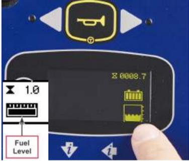
1. Überprüfen Sie die Diesel-, LPG- oder Batterieanzeige und füllen/laden ggf. auf.
