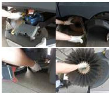
17. Entnehmen Sie die Bürsten, überprüfen Sie diese auf Abnutzung und reinigen Sie diese.
