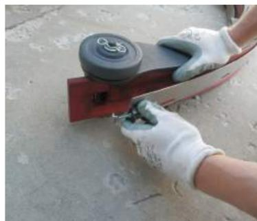
18. Nehmen Sie die Saugleiste ab und überprüfen Sie die Sauglippen auf Abnutzung und Beschädigung.
