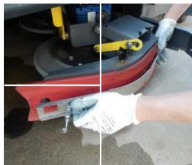
19. Entnehmen Sie die Seitenschürzen und überprüfen Sie diese ebenfalls auf Abnutzung und Beschädigung.
