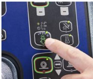
12. Bei stärkeren Verschmutzungen können Sie den Exoflex™ Druckknopf für höhere Reinigungsleistung drücken.
