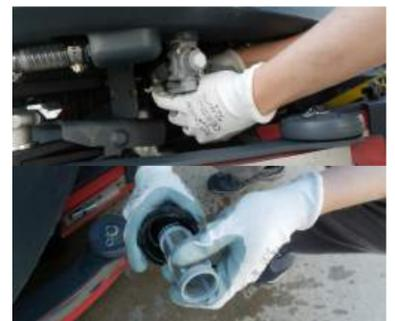
15. Schließen Sie das Frischwasserventil, entnehmen Sie den Filter und reinigen diesen.
