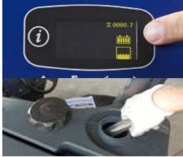
2. Überprüfen Sie den Frischwassertank und füllen Sie ggf. Frischwasser auf. Das Wasser darf nicht wärmer als 40°C sein.
