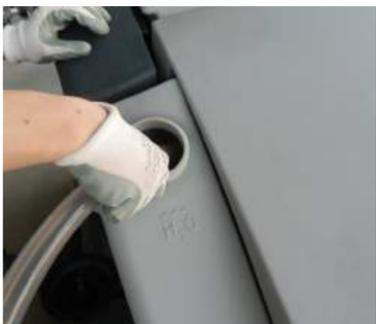
6. Falls die Maschine mit DustGuard™ ausgestattet ist, bitte den Wassertank hierfür auffüllen.
