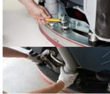
4. Setzen Sie die Saugleiste ein, befestigen Sie diese und verbinden Sie den Saugschlauch mit der Leiste.
