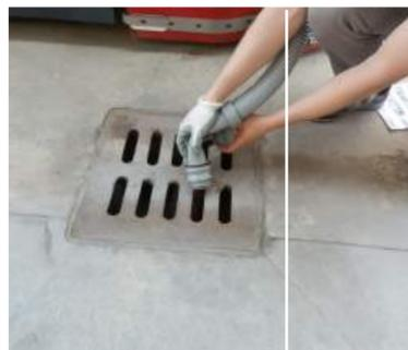
13. Entleeren Sie den Schmutzwassertank über einem Bodenablauf und ebenfalls den Frischwassertank (durchsichtiger Schlauch).
