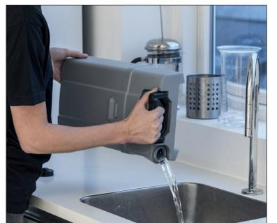
15. Beide Tanks entleeren und mit Frischwasser reinigen.
