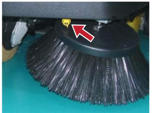
8. Bei nicht korrekter Funktion des DustGuard™-Systems (optional) entfernen Sie die Düse und prüfen Sie den Düsenfilter und reinigen diesen bei Bedarf.
