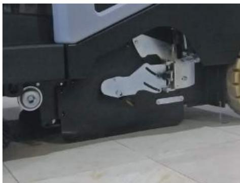
9. Prüfen Sie vor dem Kehren die Seitenschürzen auf korrekte Höheneinstellung und deren Zustand. Bei Verschleiß müssen diese ersetzt werden.
