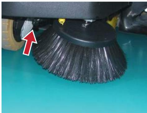
5. Prüfen Sie die korrekte Höheneinstellung der Seitenbesen und ihren Verschleißzustand. Justieren Sie bei Bedarf die Höhe über den Drehknopf nach.
