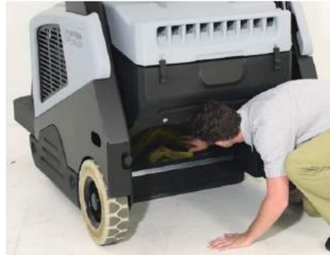
3. Prüfen Sie die Hauptkehrwalze auf Schmutz und dass diese frei drehbar ist.
