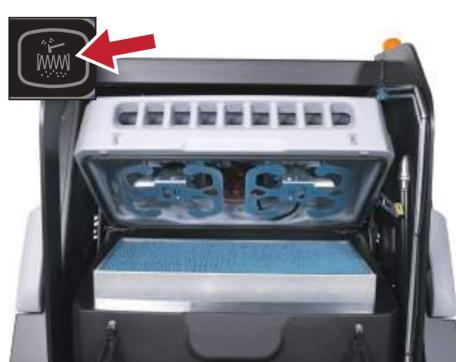
6. Prüfen Sie vor dem Kehren, ob Feinstaub austritt. Betätigen Sie bei Bedarf die Filterrütteltaste, um den Hauptfilter von Staub zu reinigen.
