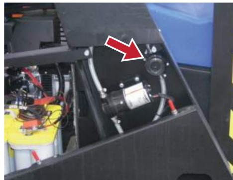
7. Beim Einsatz des (optionalen) DustGuard™-Systems entfernen Sie die rechte Abdeckung und überprüfen Sie den Wasserfilter.
