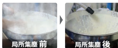
局所集塵前 局所集塵後 材料投入時の粉塵飛散を防ぐ
