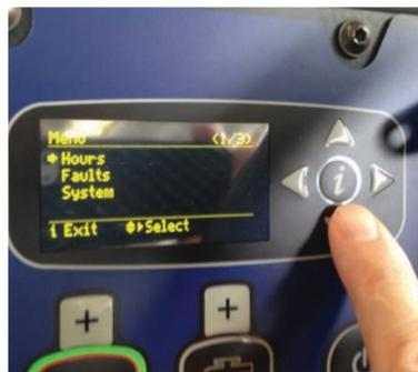
2. Drücken Sie „I“ und navigieren Sie nach unten zu den Fehlermeldungen. Die Fehlermeldungen können Sie sich über die Taste „>“ anzeigen lassen.
