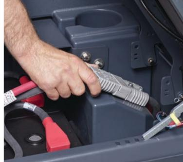
3. Prüfen Sie, ob die Batteriesteckverbindung richtig verbunden ist.
