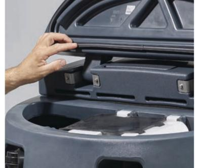
4. Die Dichtung des Schmutzwassertanks muss korrekt eingebaut, sauber und in einwandfreiem Zustand sein.
