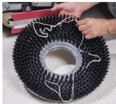
3. Drehen Sie die Bürsten gegen den Uhrzeigersinn und entnehmen Sie diese. Überprüfen Sie, ob sich Materialien in der Bürste verfangen haben, die das Drehen der Bürsten verhindern und entfernen Sie diese.
