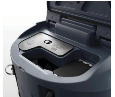
4. Schließen Sie die Schmutzwassertankabdeckung ordnungsgemäß und überprüfen Sie vorher den Verschleiß der Dichtung. Die Dichtung des Schmutzwassertanks muss korrekt eingebaut, sauber und in einwandfreiem Zustand sein.
