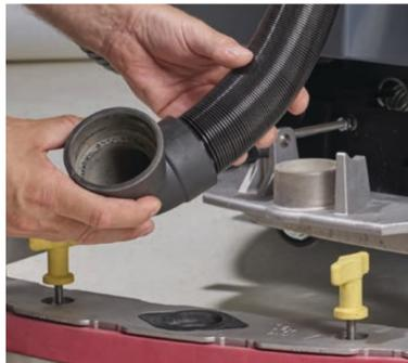
1. Prüfen Sie, ob der Saugschlauch korrekt angeschlossen und sauber ist.
