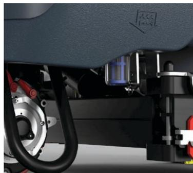
2. Prüfen Sie, ob das Ventil des Frischwassertanks geöffnet ist.
