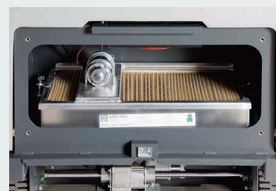
5分毎に自動でフィルター清掃が行われる電動フィルタークリーニングシステム
