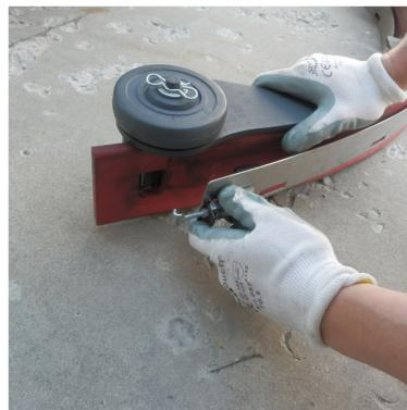
3 Entnehmen und kontrollieren Sie die Sauglippen auf Beschädigungen oder Verunreinigungen.
