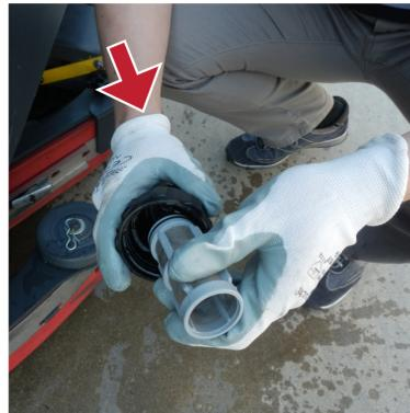
3 Kontrollieren Sie den Frischwasserfilter auf Verunreinigungen.
