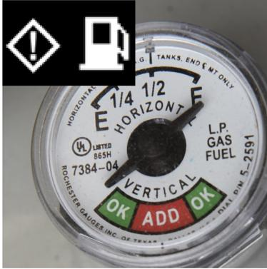
1 Überprüfen Sie die Diesel- oder LPG-Anzeige und füllen ggf. auf.
