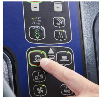
4 Stellen Sie sicher, dass der Anpressdruck der Kehrwalze korrekt eingestellt ist, um den Fehlercode „54“ zu vermeiden.
