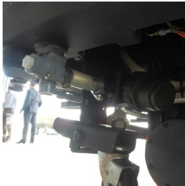
2 Prüfen Sie ob das Ventil für das Frischwasser geöffnet ist.
