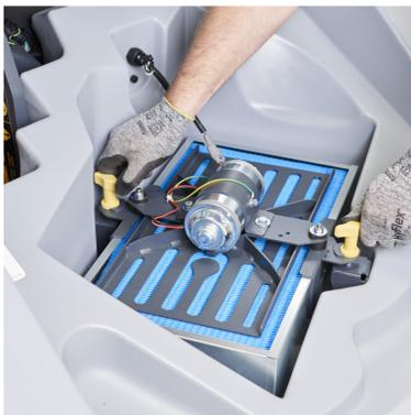
1 Das Filterelement sollte täglich überprüft werden.
