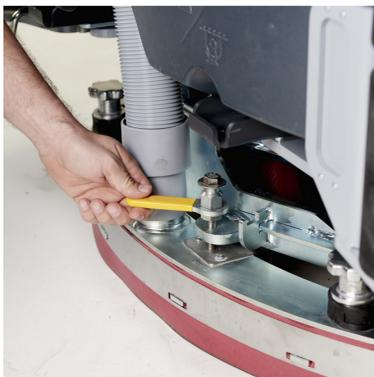
1 Überprüfen Sie, ob der Winkel der Saugleiste korrekt eingestellt ist.
