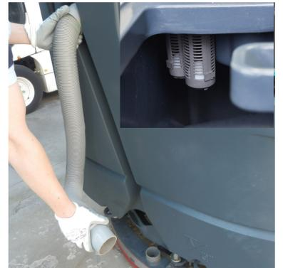
4 Prüfen Sie, ob der Saugschlauch frei von Verschmutzungen ist und reinigen diesen ggf.
