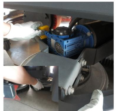
4 Öffnen Sie die Abdeckung der Kehrwalze und überprüfen Sie die Bürste.
