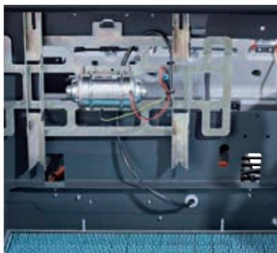
*Effiziente Filterreinigung durch einen automatischen, multi-frequenten Filterrüttler.*
