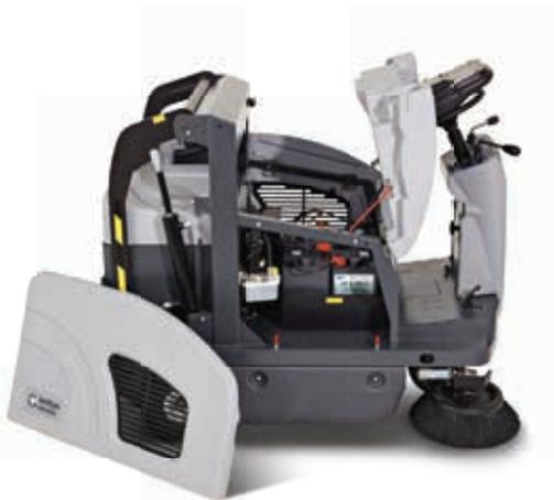
*MaxAccess™ – Rundum guter Zugang zu allen Komponenten und werkzeugfreier, schneller Wechsel von Bürsten und Walze.*
