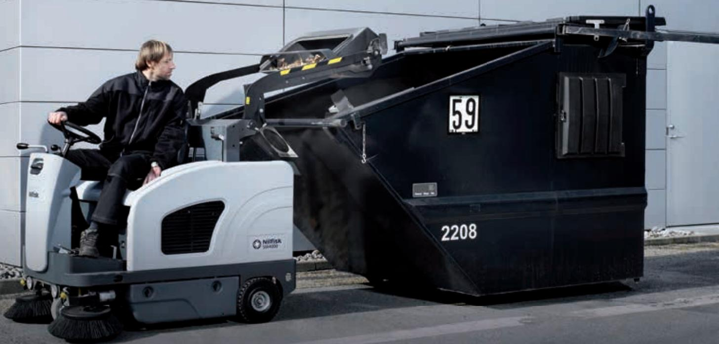
*Die hydraulische Hochentleerung kann aus dem Sitzen geschlossen werden, dies erlaubt eine schnelle und sichere Entleerung. Der Fahrer kann unmittelbar nach dem Entleerungsvorgang weiter fahren.*
