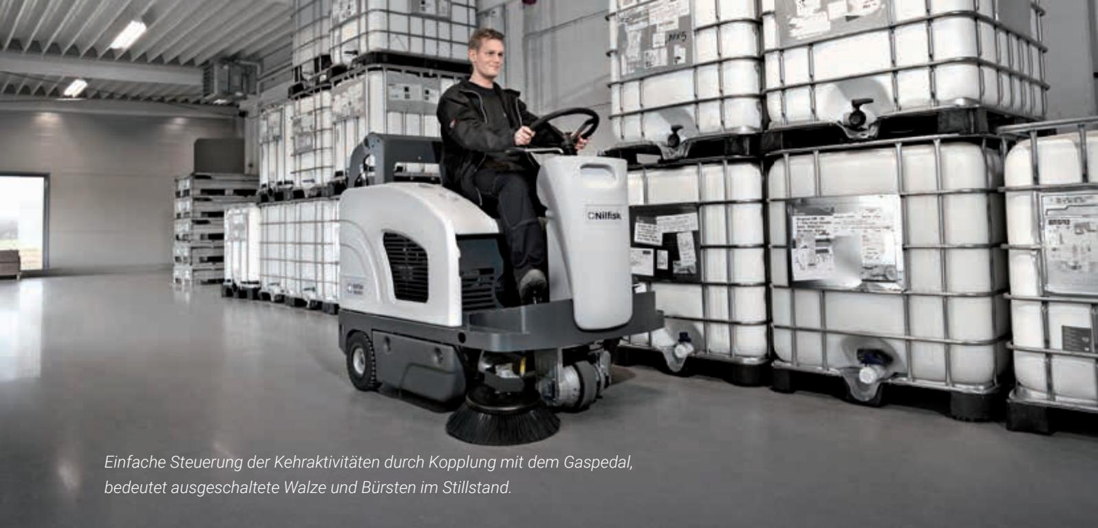
Einfache Steuerung der Kehraktivitäten durch Kopplung mit dem Gaspedal, bedeutet ausgeschaltete Walze und Bürsten im Stillstand.
