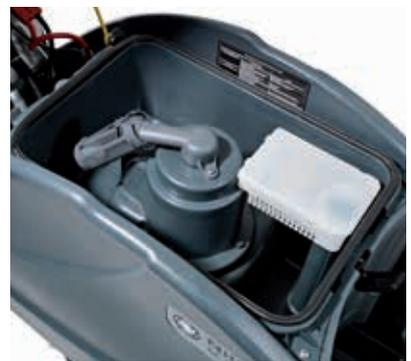
Der 44-Liter-Tank ermöglicht eine Reinigungszeit von bis zu 75 Minuten pro Tankfüllung.
