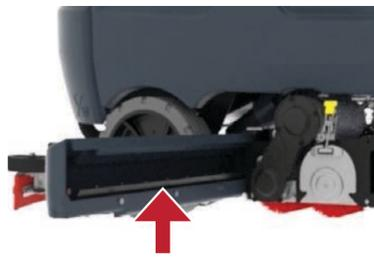
13. Ziehen Sie den Schmutzkäfig heraus und kontrollieren, entleeren und reinigen Sie ihn (zylindrische Version).
