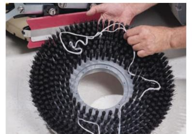
14. Drehen Sie die Bürsten gegen den Uhrzeigersinn und nehmen Sie die Bürsten oder Padhalter ab. Beseitigen Sie ggf. grobe Verunreinigungen. Spülen Sie die Bürsten oder Pads mit warmem Wasser aus und hängen Sie sie zum Trocknen auf.
