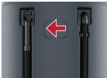
12. Entleeren Sie den Schmutzwasserbehälter mit dem quetschbaren Ablassschlauch. Leeren Sie den Grobschmutzkorb und reinigen bzw. spülen Sie das Innere des Schmutzwassertanks aus.
