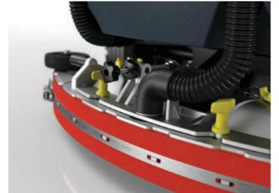
5. Überprüfen Sie, ob die Sauglippen sauber und frei von Beschädigungen sind. Setzen Sie die Saugleiste ein und befestigen Sie diese mit den gelben Stellschrauben. Ändern Sie bei Bedarf die Höhe der Saugleiste durch Verstellen der Lenkrollen und des Neigungshebels.
