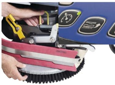
6. Bürstenaufnahme: Drücken Sie die Führungsstange nach vorne und schieben Sie die Bürste bis zum Anschlag unter das Deck. Wiederholen Sie diesen Schritt für die Bürste auf der anderen Seite des Decks. Schalten Sie die Maschine ein und drücken die Taste zur Bürstenaufnahme (nur bei Tellerbürsten-Version).
