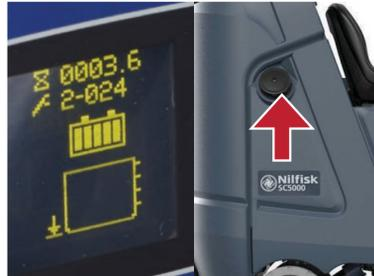
3. Füllen Sie den Tank mit Frischwasser (max. 40°). Die Anzeige für den Füllstand befindet sich auf dem Display. Stellen Sie auch sicher, dass das Frischwasserventil unter der Maschine geöffnet ist.
