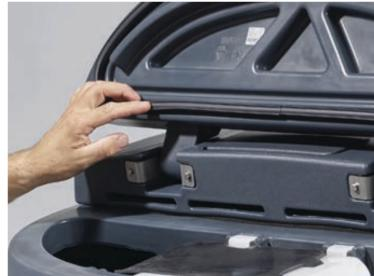
4. Die Dichtung des Schmutzwassertanks muss korrekt eingebaut, sauber und in einwandfreiem Zustand sein.
