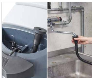
1. Den Tank mit sauberem Wasser füllen und gemäß der Anleitung ein geeignetes Reinigungsmittel hinzugeben. Die Temperatur des Wassers darf höchstens 40 °C betragen.
