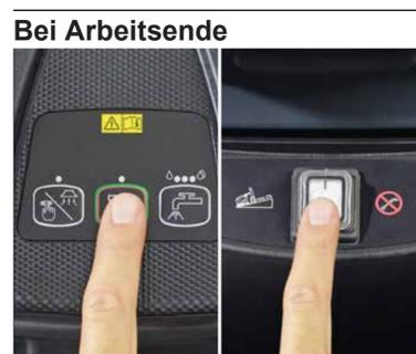
10. Die Einschalttaste erneut drücken, um die Funktionen abzuschalten (LED aus), den Hauptschalter auf „0“ stellen. Entfernen Sie den Stecker aus der Steckdose.
