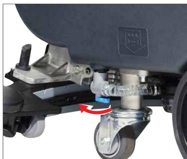
2. Darauf achten, dass das Ventil unter der Maschine geöffnet ist.
