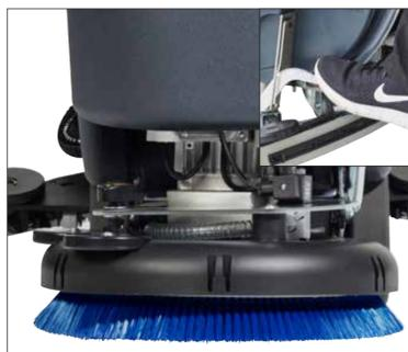
4. Die Bürste oder den Pad-Halter unter das Bürstendeck legen. Immer eine für den jeweiligen Boden geeignete Bürste / Pad verwenden. Pedal treten, um das Deck abzusenken.
