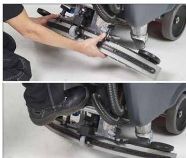
3. Die Saugleiste einlegen und mit den Stellschrauben befestigen. Pedal treten, um die Saugleiste abzusenken.
