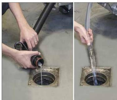
13. Den Schmutzwassertank mit dem Schlauch entleeren. Dann den Frischwassertank mit dem transparenten Schlauch entleeren
