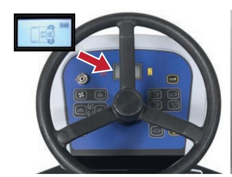
1. Prüfen Sie den LPG-Füllstand oder den Batterieladezustand.
