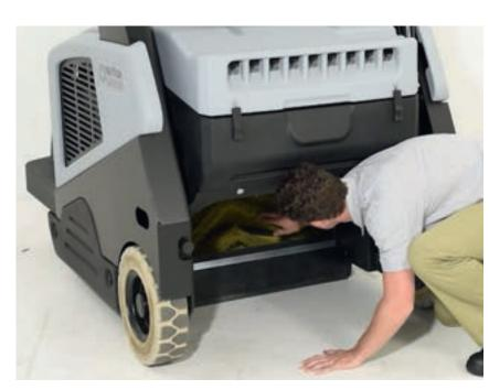
3. Prüfen Sie die Hauptkehrwalze auf Schmutz und dass diese frei drehbar ist.
