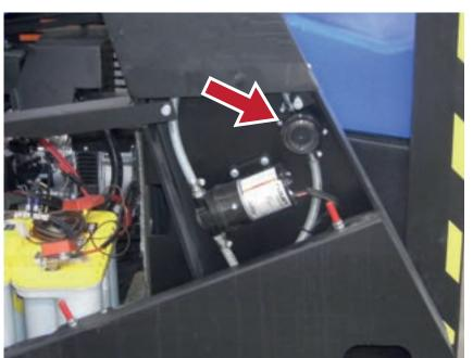
7. Beim Einsatz des (optionalen) DustGuard™-Systems entfernen Sie die rechte Abdeckung und überprüfen Sie den Wasserfilter.
