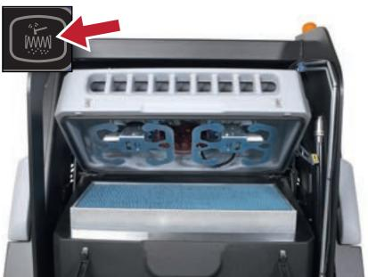
**6.** Prüfen Sie vor dem Kehren, ob Feinstaub austritt. Betätigen Sie bei Bedarf die Filterrüttlertaste, um den Hauptfilter von Staub zu reinigen.
