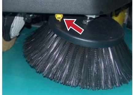
8. Bei nicht korrekter Funktion des DustGuard™-Systems (optional) entfernen Sie die Düse und prüfen Sie den Düsenfilter und reinigen diesen bei Bedarf.
