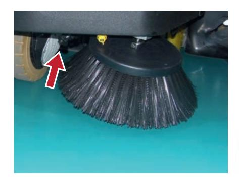
5. Prüfen Sie die korrekte Höheneinstellung der Seitenbesen und ihren Verschleißzustand. Justieren Sie bei Bedarf die Höhe über den Drehknopf nach.
