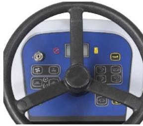
すべての機能は、ダッシュボードからボタンを押してドライブペダルを作動させることで一度に起動します。
