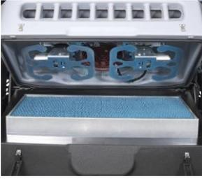
フィルターシェイカーの動作—自動的に設定された時間ごとにフィルターを振動させ・吸引を止めます。
