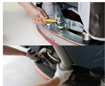
3. Füllen Sie den EcoFlex™ Reinigungs- 4. Setzen Sie die Saugleiste ein, befestigen Sie diese und verbinden Sie den Saugschlauch mit der Leiste.
