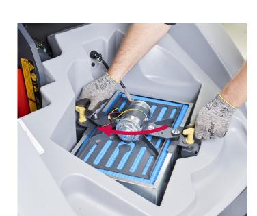
16. Öffnen Sie die Abdeckung zum Filter, entnehmen Sie den Filter und reinigen ihn.
