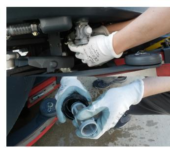
15. Schließen Sie das Frischwasserventil, entnehmen Sie den Filter und reinigen diesen.
