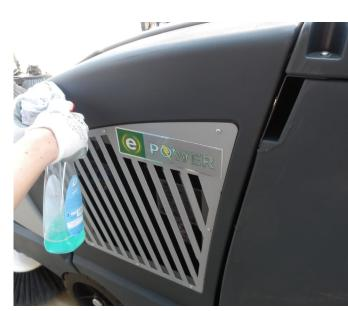
20. Reinigen Sie die Maschine mit einem milden Reinigungsmittel und einem feuchten Tuch. Öffnen Sie die Wassertanks zum Austrocknen.
