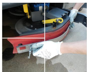
19. Entnehmen Sie die Seitenschürzen und überprüfen Sie diese ebenfalls auf Abnutzung und Beschädigung.
