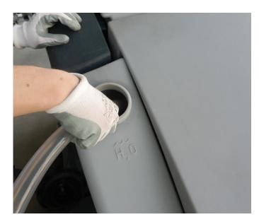
6. Falls die Maschine mit DustGuard™ ausgestattet ist, bitte den Wassertank hierfür auffüllen.
