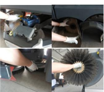
17. Entnehmen Sie die Bürsten, überprüfen Sie diese auf Abnutzung und reinigen Sie diese.
