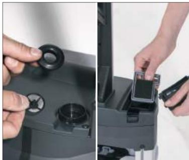
16. Überprüfen Sie die Frisch- und Schmutzwassertanks regelmäßig und reinigen diese bei Bedarf.
