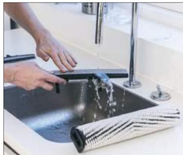
19. Reinigen Sie nun Saugleisten und Bürste. Überprüfen Sie die Teile hierbei auch Beschädigungen und ersetzen diese ggf..
