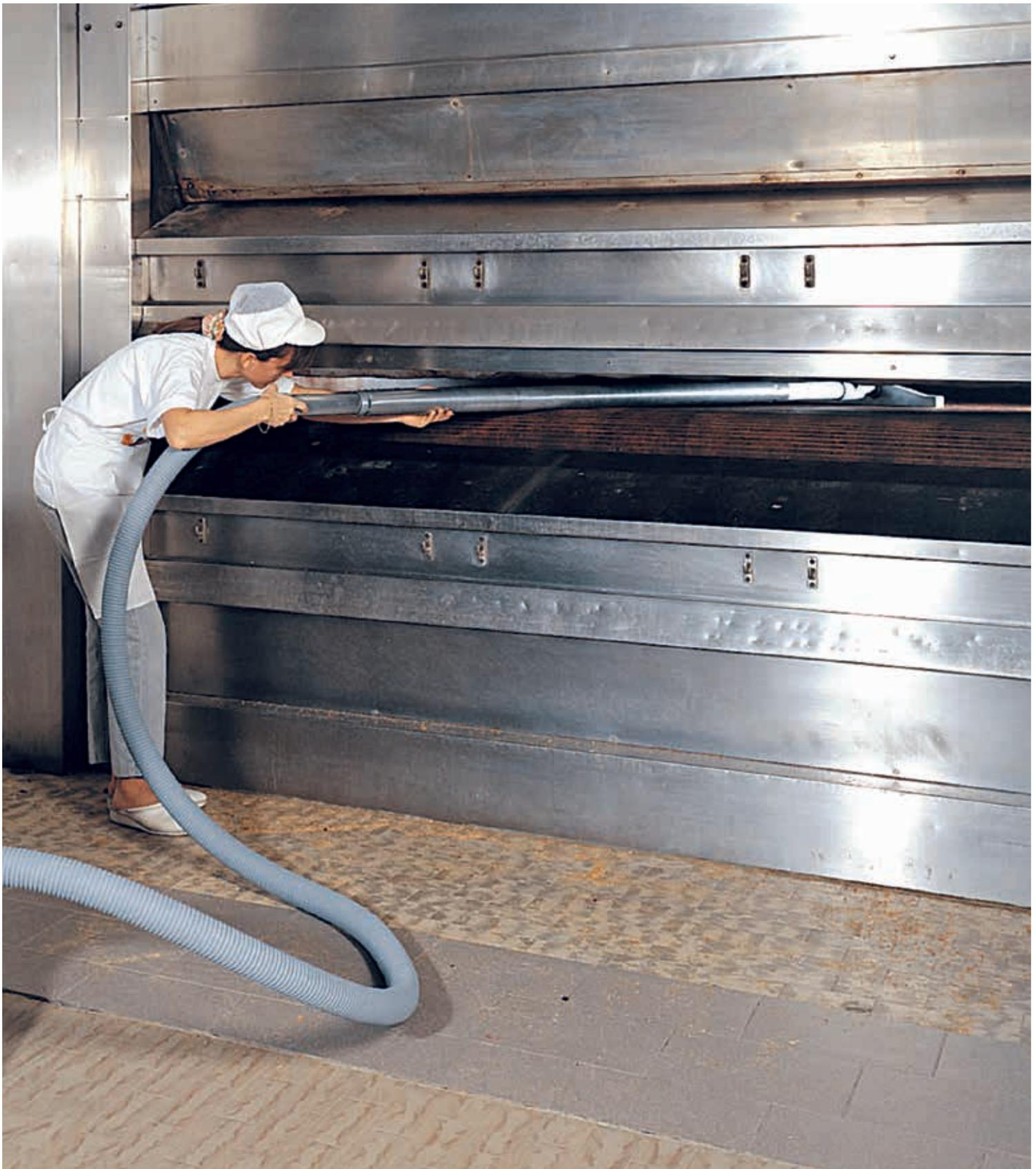
Industriesauger eignen sich ausgezeichnet, für eine Ofeninnenreinigung. So sind beispielsweise Industriesauger mit NOMEX-Filter (selbstverlöschendes Material) sogar zum Aufsaugen weißglühender Materialien geeignet. Für alle Umgebungen mit möglicher Explosionsgefahr durch Mehl bietet Nilfisk einen ATEX-zertifizierten Industriesauger an.
