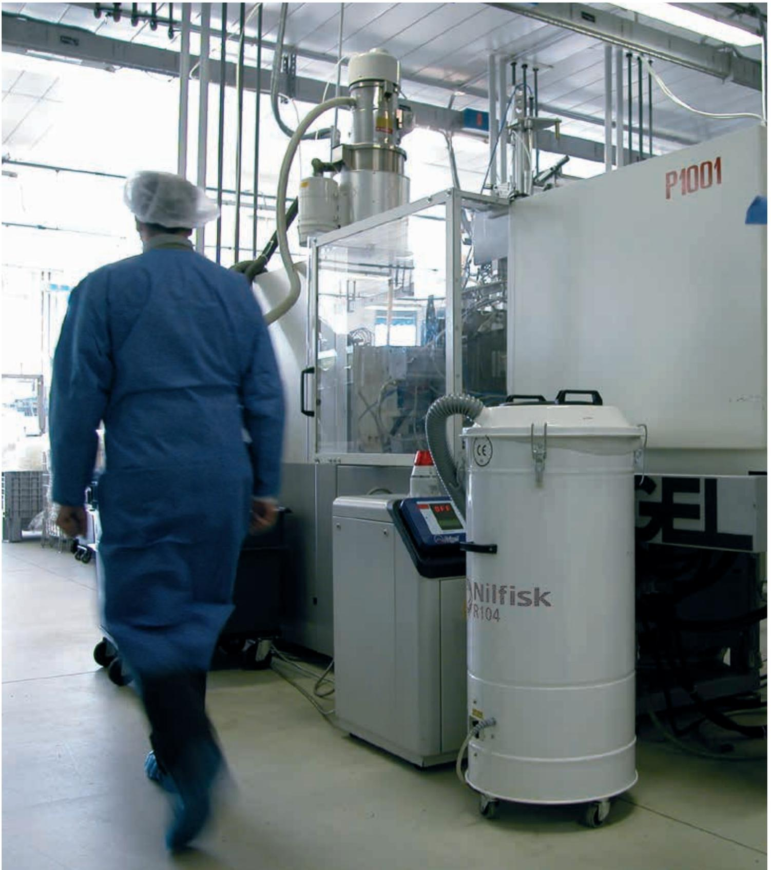
Nilfisk stellt eine Reihe von Industriesaugern bereit, die sich zum Aufnehmen von Produktionsabfällen sowie Kunststoff-, Papier- und Gewebeabfällen eignen. Die Industriesauger sind so konstruiert, um Verschnittreste und Fertigungsstäube abzusaugen und dabei zu komprimieren, um sie gegebenenfalls anschließend wieder dem Wertstoffkreislauf zurückführen zu können.
