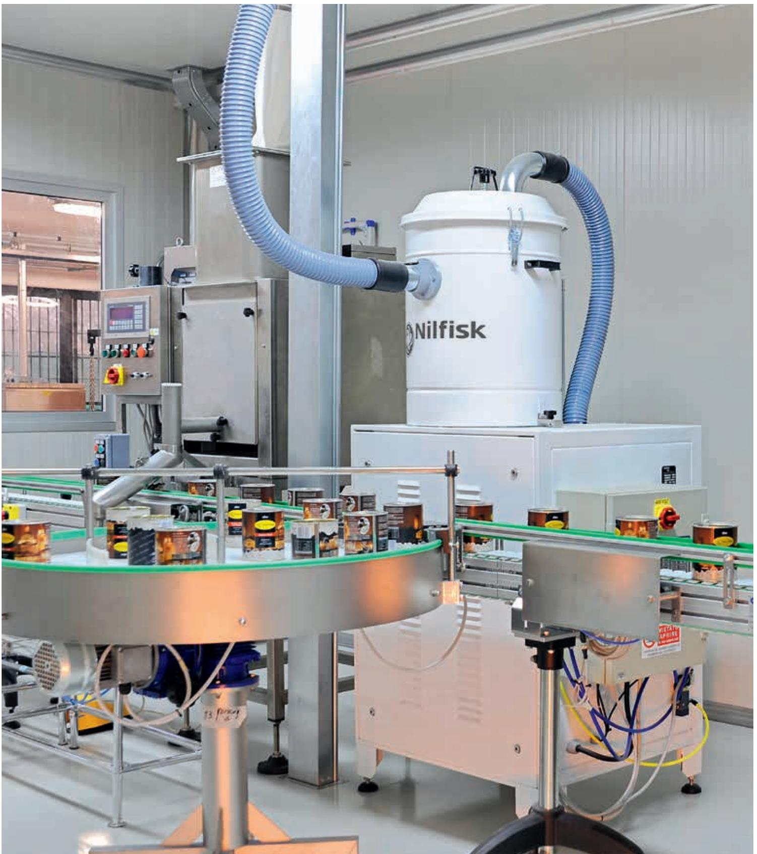
Pneumatische Produktförderanlagen von Nilfisk eignen sich optimal für den Transport von Pulver oder Getreide, das direkt aus Säcken, Big-Bags oder anderen Behältern entnommen und nach den gewünschten Zeit- und Mengeneinstellungen in einer bestimmten Entfernung in weiterverarbeitende Maschinen abgegeben wird. Durch den Einsatz pneumatischer Produktförderanlagen ist es möglich, ein Produkt von einem Ort aus gleichzeitig an verschiedene Stellen zu transportieren und umgekehrt. Dieser
