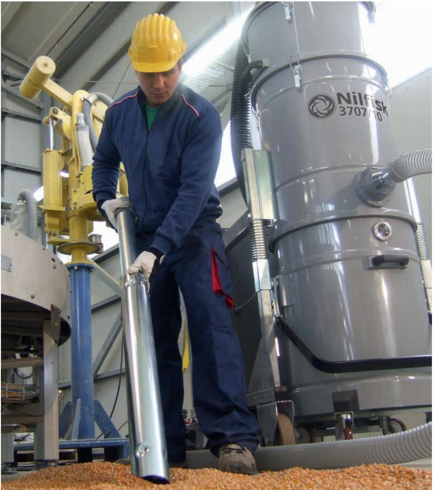
Trocknungsanlagen und Silos sorgen für eine hohe Getreidequalität. Ernten können auch bei schlechten Wetterbedingungen eingebracht werden. Das einfache und rasche Entleeren der Silos und Trocknungsanlagen mithilfe von Nilfisk Industriesaugern gewährleistet einen raschen Wechsel der Trocknungsphasen.
