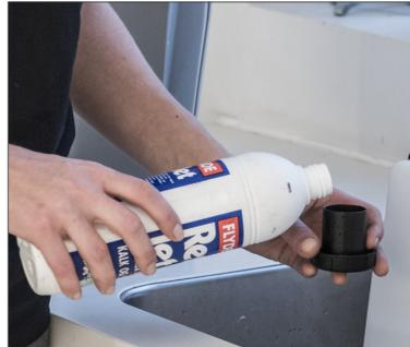
3. Der Tankdeckel kann zum Dosieren des Reinigungsmittels verwendet werden. Ein voller Deckel enthält 30 ml, was bei einem Tankinhalt von 6 l eine 0,5%ige Reinigungsmittelkonzentration ergibt.
