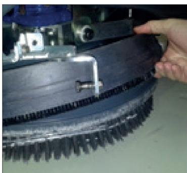
1. Überprüfen Sie bitte, ob die Bürste korrekt sitzt oder ob sie zu weit abgenutzt ist. Bei Bedarf bitte ersetzen.
