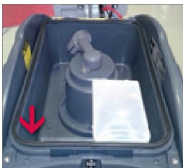
4. Schließen Sie den Schmutzwassertank korrekt und stellen Sie bitte sicher, dass die Dichtungen unbeschädigt sind.
