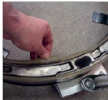
3. Prüfen Sie bitte, ob die Saugleisten beschädigt oder verschmutzt sind und reinigen/ersetzen Sie diese.
