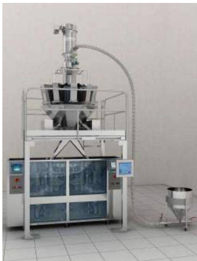
Remplissage de l'unité de dosage sur double machine d'emballage vertical
