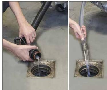
14. Den Schmutzwassertank mit dem quetschbaren Ablass-Schlauch entleeren. Dann den Frischwassertank mit dem transparenten Schlauch entleeren.
