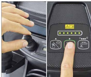
7. Wenn die Maschine einen Schlüsselschalter hat, diesen auf „I“ stellen und dann die Einschalttaste einmal drücken, um die Maschine einzuschalten. Die Batterieanzeige geht an.
