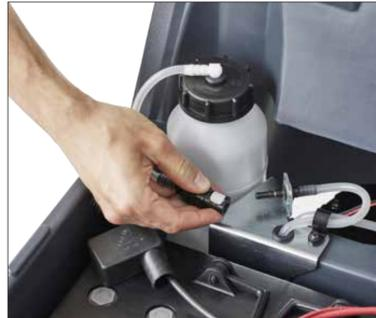
3. Wenn die Maschine über ein Reinigungsmittel-Mischsystem verfügt: Die Flasche mit einem für Reinigungsmaschinen geeigneten Reinigungsmittel (hochkonzentriertes Reinigungsmittel mit geringer Schaumbildung) füllen.
