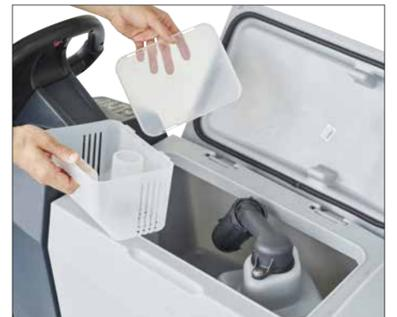
15. Den Grobschmutzbehälter entleeren und reinigen sowie den Schmutzwassertank reinigen/auswaschen.
