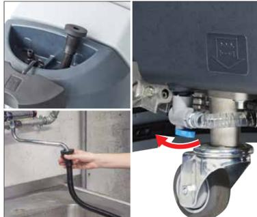
2. Den Tank mit sauberem Wasser füllen und ggf. ein geeignetes Reinigungsmittel hinzugeben. Die Temperatur des Wassers darf höchstens 40 °C betragen. Darauf achten, dass das Ventil unter der Maschine geöffnet ist.
