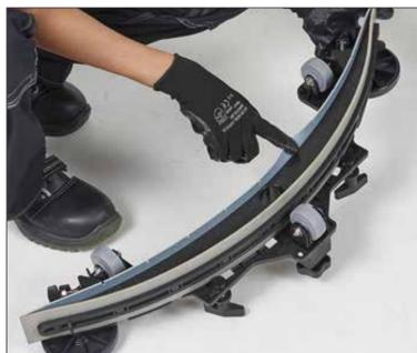
17. Die Saugleiste abnehmen und groben Schmutz entfernen. Die Saugleisten auf Beschädigungen kontrollieren und reinigen.
