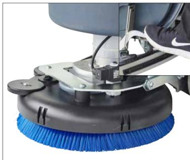
6. Die Bürste oder den Pad-Halter unter die Halterung legen. Immer eine für den jeweiligen Boden geeignete Bürste / Pad verwenden. Pedal betätigen, um das Deck abzusenken.
