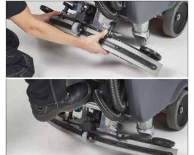
5. Die Saugleiste einhängen und mit den Stellschrauben befestigen. Pedal betätigen, um die Saugleiste abzusenken.
