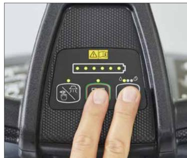
9. Bei empfindlichen Böden kann die Bürste/das Pad vor dem Beginn der Arbeit angefeuchtet werden, um Einbrennflecken zu vermeiden. Die Einschalttaste und die Frischwassertaste gleichzeitig 10 bis 20 Sekunden lang gedrückt halten, bevor mit der Arbeit begonnen wird.
