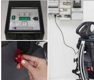
1a (Externes Ladegerät) Ziehen Sie das Ladekabel heraus. Verbinden Sie es wieder mit der Maschine.
