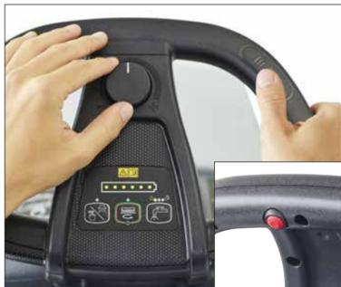
11. (Für Modell mit Antrieb.) Bei Bedarf die Geschwindigkeit am Knopf für die Geschwindigkeitsregulierung einstellen. Zum Rückwärtsfahren die Rückwärtstaste am Griff drücken und gleichzeitig einen Touch-Sensor berühren.
