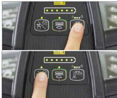
12. Die Taste für die Frischwassermenge drücken, um den Durchfluss an den Grad der Verschmutzung anzupassen. Wenn die LEDs aus sind, ist die Frischwasserzufuhr ausgeschaltet. Bei Bedarf die Taste für den Flüstermodus drücken, um den Geräuschpegel zu senken (LED blinkt).
