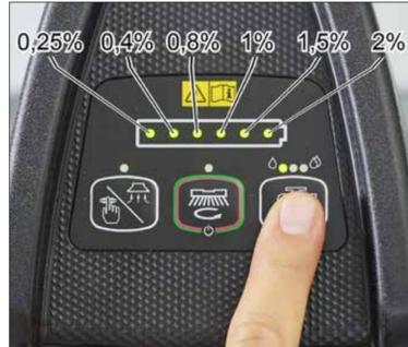
4. (Wenn die Maschine über ein Reinigungsmittel-Mischsystem verfügt) Maschine einschalten (nur Batterie-LED leuchtet). Den Anteil des Reinigungsmittels ändern, indem die Taste für die Reinigungslösung 2 Sekunden lang gedrückt wird. Dann diese Taste erneut drücken, um die Batterie-LED auf die gewünschte Einstellung zu bringen.
