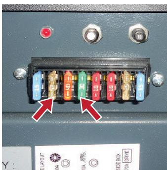
5. Überprüfen Sie, ob die Filterrüttler-Sicherung (F2) oder und die Sicherung des Vakuumsystems der Absaugung (F4) nicht ausgelöst hat.
