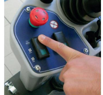
3. Reinigen Sie den Panelfilter durch Drücken des Filterrüttlerschalters.
