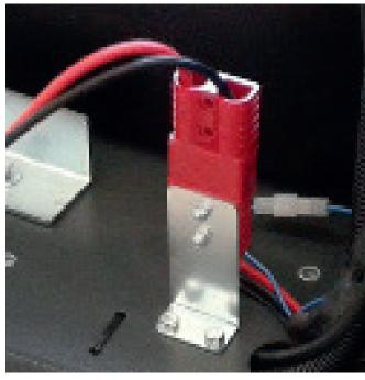
2. Prüfen Sie, ob die Batteriesteckverbindung richtig angeschlossen ist.
