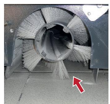
2. Öffnen Sie die Abdeckung zur Kehrwalze. Überprüfen oder ersetzen Sie die Kehrwalze, wenn die Borsten abgenutzt sind.
