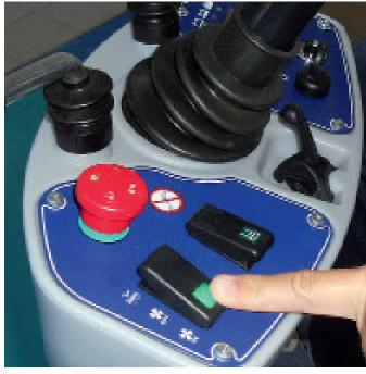
2. Prüfen Sie, ob der Schalter für die Absaugung eingeschaltet ist.
