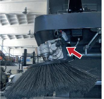
**3.** Stellen Sie die Position des Seitenbesens mit der Stellschraube ein. Ersetzen Sie den Seitenbesen, wenn die Borsten abgenutzt sind.
