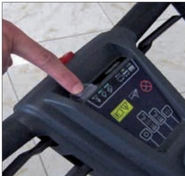
7. Drücken Sie je nach Art und Reinigungsanforderung die Taste für die Dosierung der Reinigungsmittellösung.
