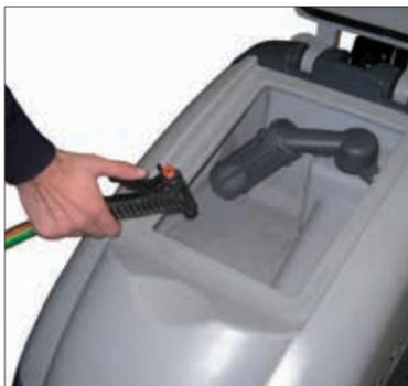
12. Spülen Sie mit sauberem Wasser den Schmutzwassertank und den Gitterrost des Schwimmers.
