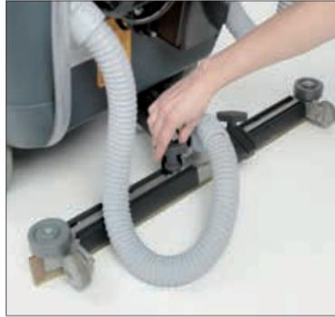
3. Installieren und befestigen Sie zuerst die Saugleiste mit den oberen Drehknöpfen, und anschließend den Saugschlauch.
