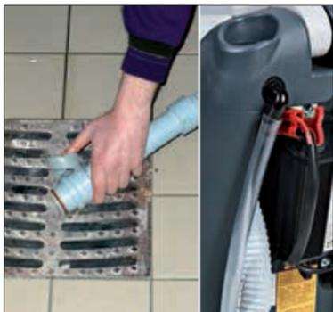
11. Entleeren und reinigen. Entleeren Sie den Schmutzwassertank mit dem Ablassschlauch. Anschließend entleeren Sie bitte den Frischwassertank mit dem durchsichtigen Schlauch.
