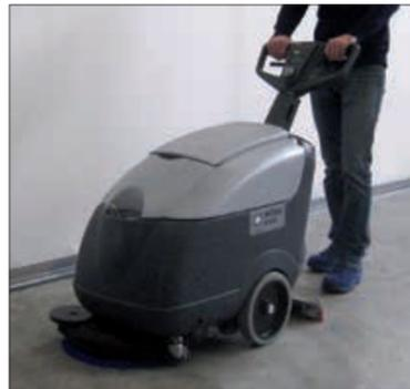
9. Halten Sie den Einschalt- und den Bürstenhebel gleichzeitig gedrückt und starten Sie in den Reinigungsmodus.
