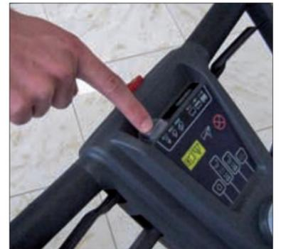
10. Sollte Reinigungsmittellösung außerhalb des Bürstengehäuses während des Reinigungsgangs austreten, reduzieren Sie die Durchflussmenge.
