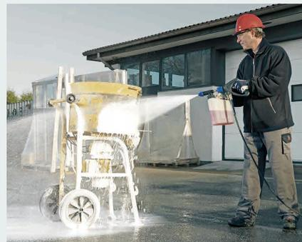
標準装備の外付けフォームスプレーシステムで、洗浄効果が大幅にアップ
