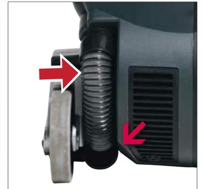
4. Ist der Saugschlauch verunreinigt oder nicht korrekt aufgesteckt? Bitte Schmutz entfernen und Saugschlauch richtig befestigen.
