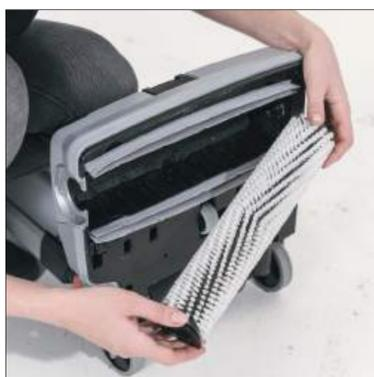
1. Prüfen Sie, ob die Bürste richtig eingesetzt ist oder ob Fremdkörper vorhanden sind, die verhindern, dass sich die Bürste dreht. Bei einer Abnutzung der Bürste sollte diese ersetzt werden.
