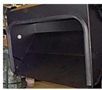
8. Versichern Sie sich, dass die Kehrgut9. Falls ein DustGuard™-System zum Behälter-Dichtung ordnungsgemäß sitzt und unbeschädigt ist, um eine gute Staubkontrolle zu gewährleisten.
