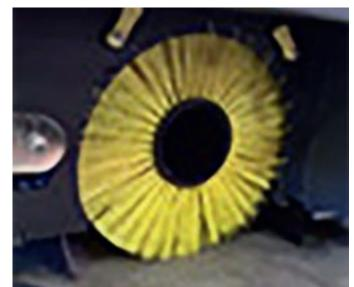
4. Überprüfen Sie, dass die Hauptkehrwalze ordnungsgemäß rotiert und frei von Schmutz und Seilen ist.
