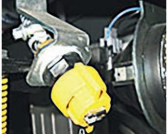
10. Testen Sie, ob Wasser aus den DustGuard™-System Düsen kommt.
