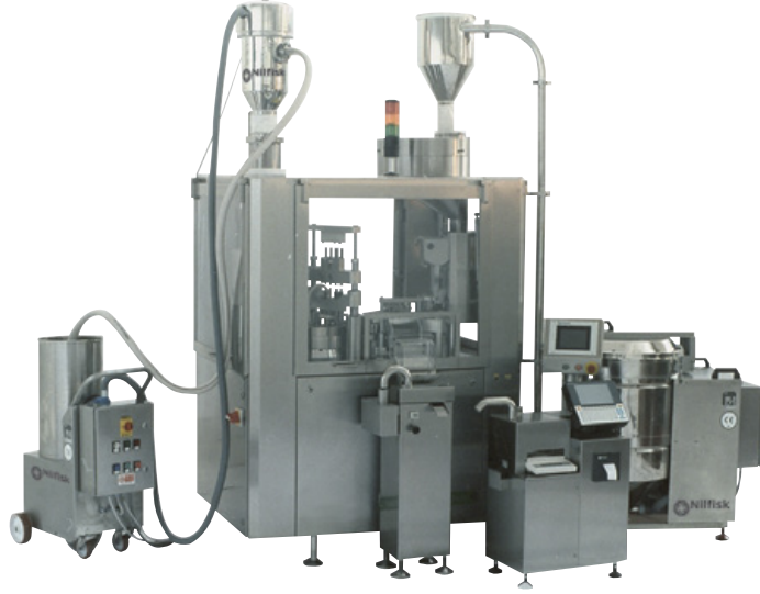
Bir ilaç şirketinde pnömatik konveyör (sol) ve kapsül itici (sağ).
