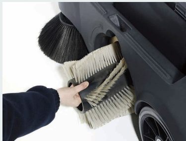
フィルター、ブラシは工具が不要で容易に交換が可能
