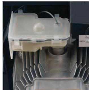
Réservoir d'huile avec sécurité niveau bas intégré. L'entretien est simplifié et la machine est protégée contre le fonctionnement de la pompe sans huile, assurant une longévité accrue.
