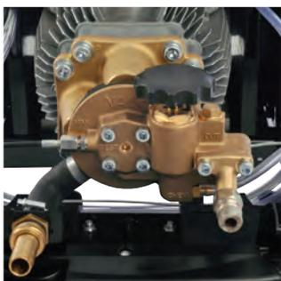
Système FA "Flow Activated" de décompression automatique: plus de confort et protection du moteur contre les fuites.
