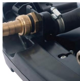
Double système d'étanchéité (joints primaires et joints secondaires) avec canal d'évacuation des fuites de la pompe, augmentant le temps entre les opérations de maintenance et empêchent le blocage des pistons dû à l'usure des joints d'étanchéité primaires.
